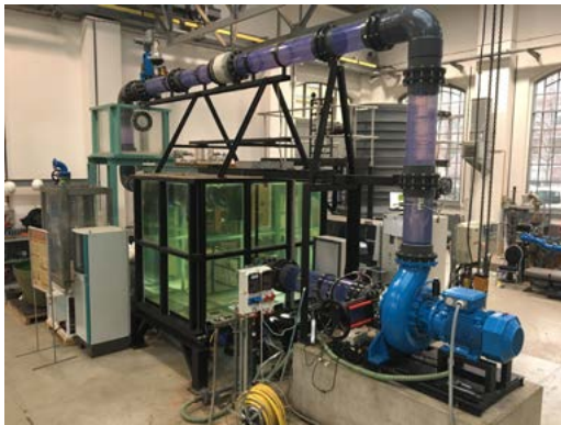
Bild 2: Prüfstands Aufbau TU-Berlin mit einer EOA 8-250 HF6
